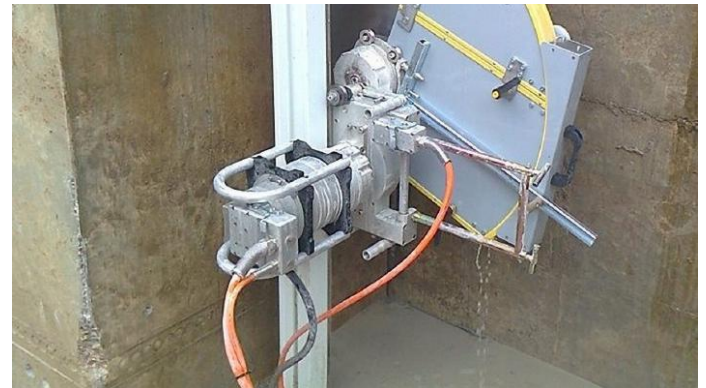
Betonsägemaschine / Concrete saw
